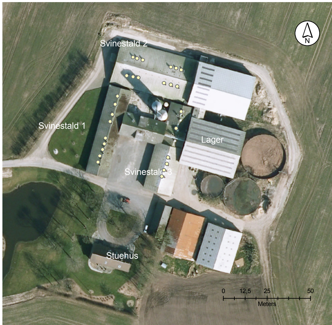
Figur 3: Placering af ventilationsafkast på de enkelte staldafsnit
