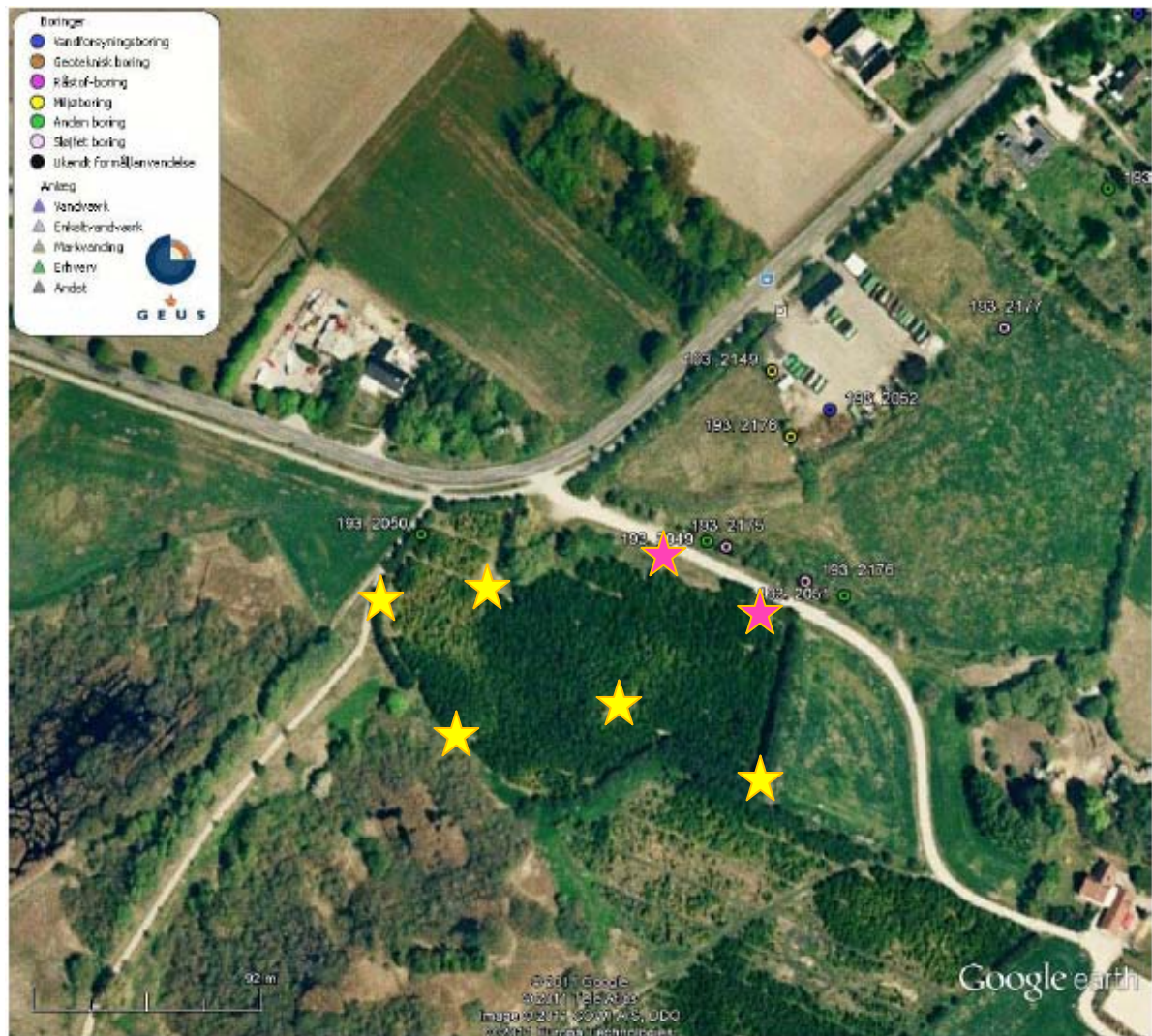
Figur 8.1 Placering af nye monitorings- og undersøgelsesboringer. Pink stjerner angiver lokaliseringsboringer, gule stjerner filterboringer
