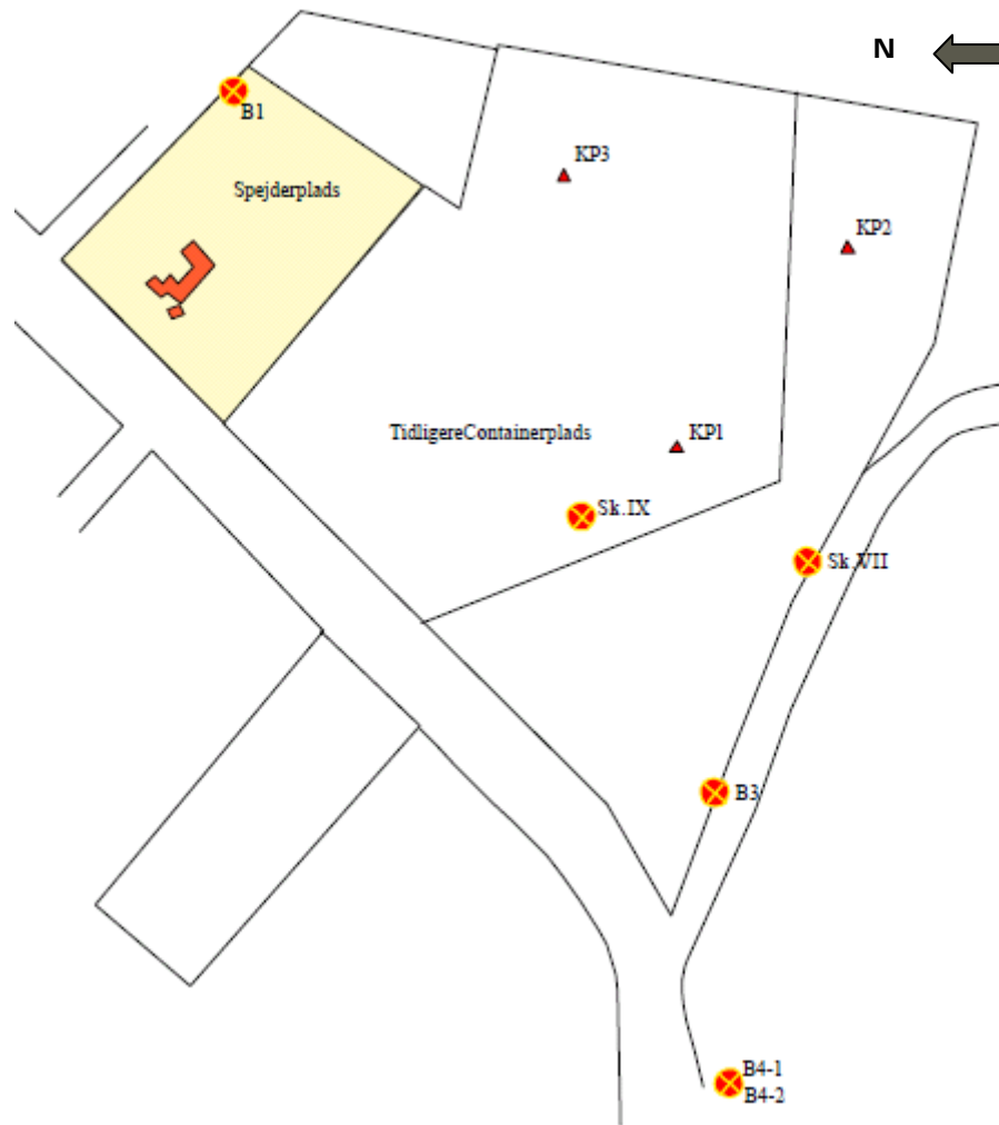
Figur 4.1 Situationsplan – boringer, fra /1/, bemærk at figuren er vendt i forhold til verdenshjørnerne, nord er således mod venstre
