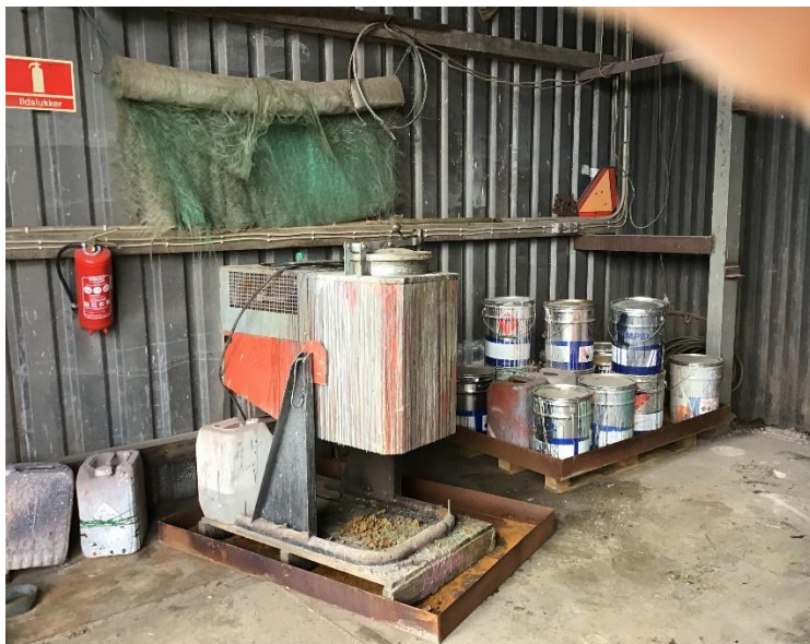
Koger til udtrækning af fortynder fra malingsrester. Fortynderen genanvendes, malingsresten afhentes af Miljøcenter Vendsyssel.
