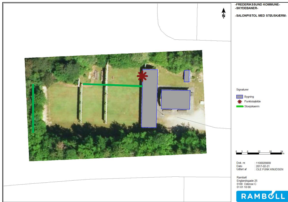
Figur 4 Placering af planlagte sikkerhedsafskærmning og ekstra skærm på toppen af 50 meter banens endevold (grønne linjer)
