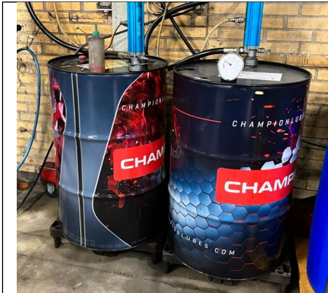
Olie uden opsamling i værksted med afløb
