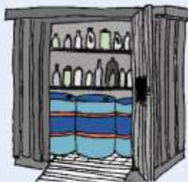
Figur 2: Udendørs opbevaring i container med dobbelt bund.
