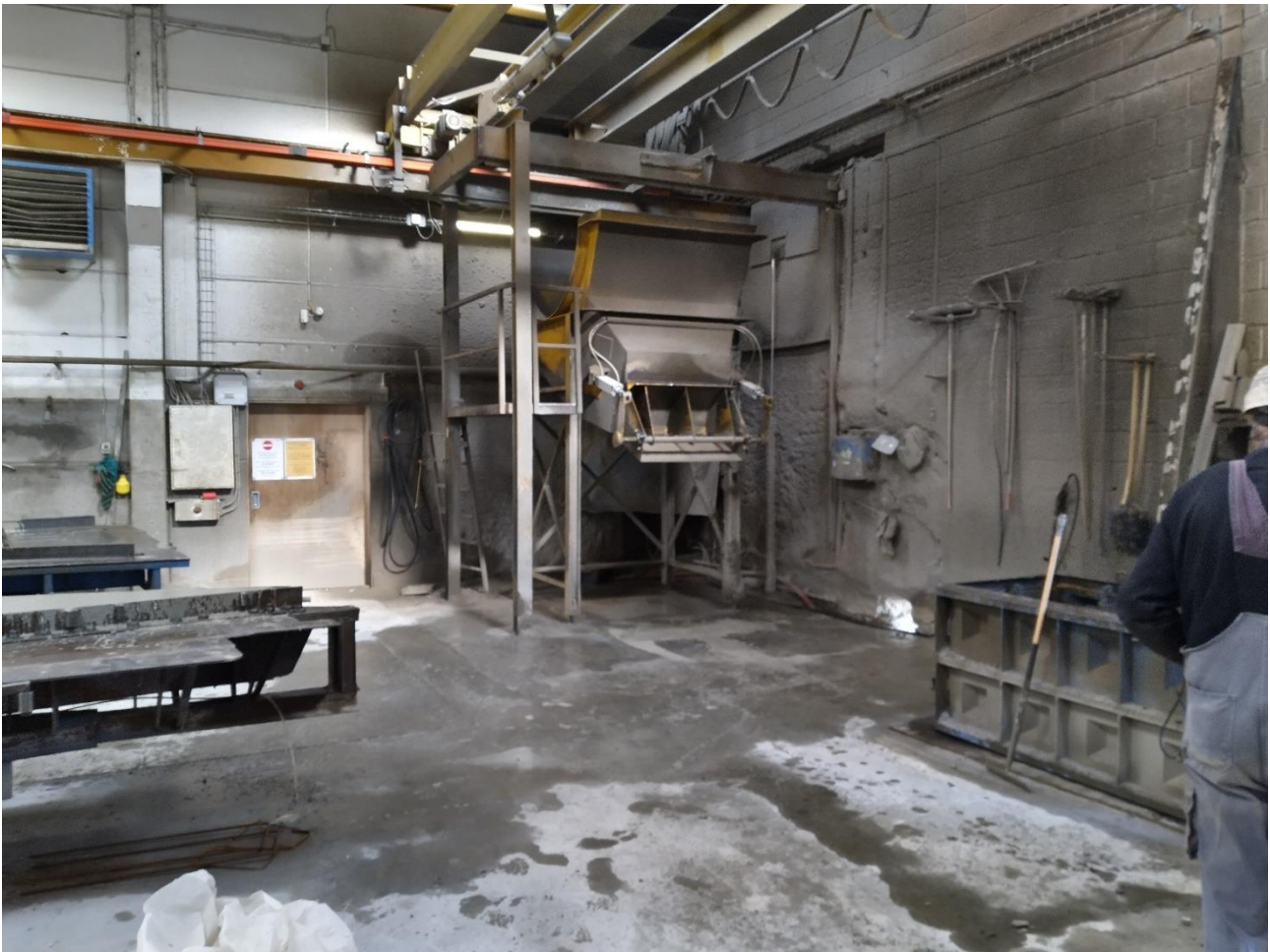
Figur 7. Støbehal 4, hvor aftipningskasser vaskes. Vaskevand ledes via hul/rende i væggen ud til slambassin C.
