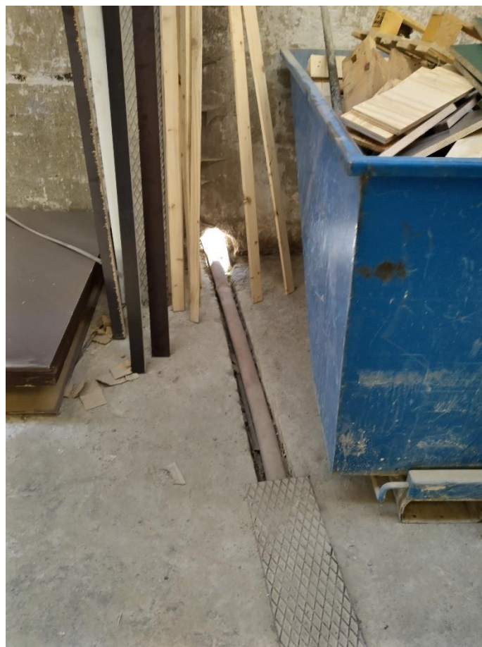
Figur 3. Brandslange udleder vand fra conveyer og blandemaskine 2 til slambassin A.
