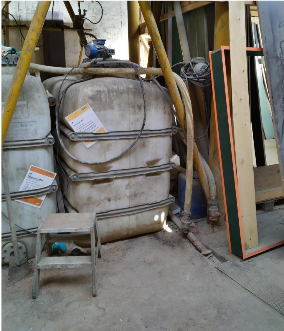
Figur 2. Vaskevand fra blandemaskine 2, der ledes via brandslange i gulvet til slambassin A.
