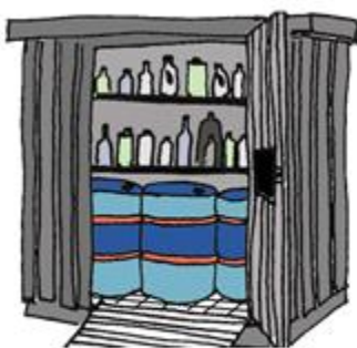
Figur 2 Udendørs opbevaring i container med dobbelt bund.
