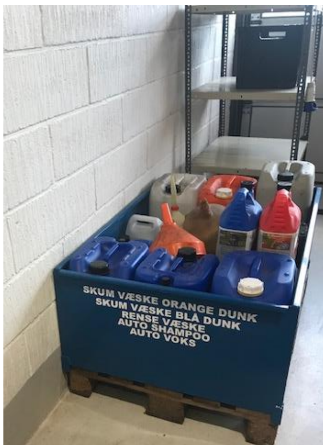
Billede 1. Opbevaring af kemikalier i en tæt opsamlingsbeholder.
