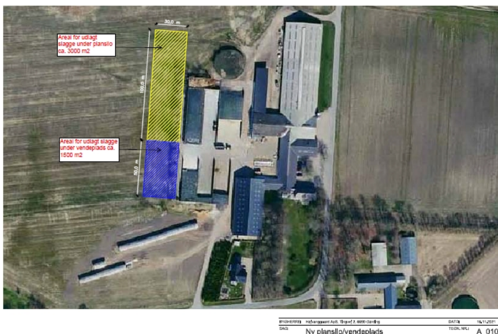
Kort 1: Placering af affaldsforbrændingsslagge. Der lægges slagge ud på det gule areal til plansiloen, på det blå areal til vendepladsen. Luftfoto fra situationsplan.
