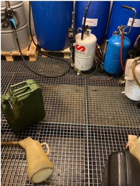
Flydende autoprodukter placeret indendørs over sikringskar.
