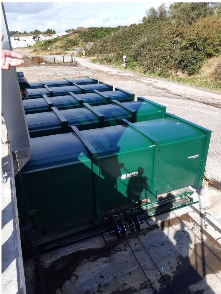
Foto 9 containere på skinner, der bliver fyldte direkte fra tragten.
