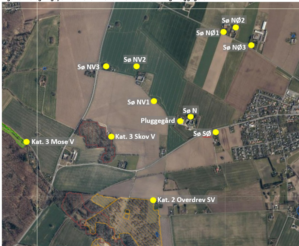
Figur 5. Beregningspunkter for ammoniak i området omkring Pluggegård.
