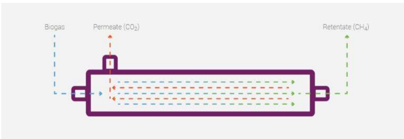
Figur 1 Principskitse af funktionaliteten i et membranopgraderingsanlæg.
