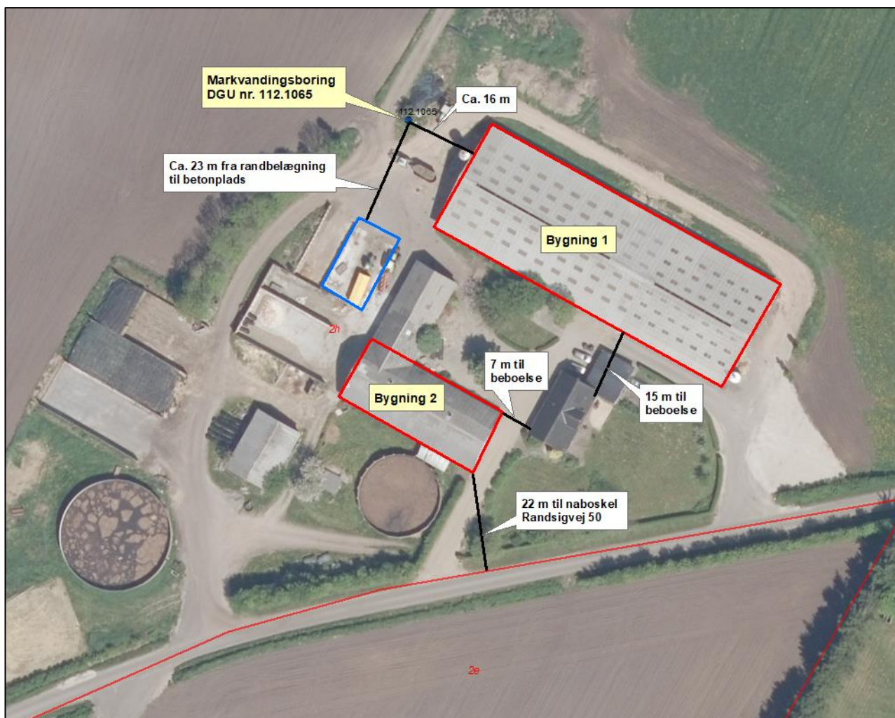
Figur 3. Placering af anlæg i forhold til boring, beboelse på samme ejendom og matrikelskel
