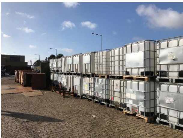
Tomme palletanke benyttes til opbevaring af metaller, når toppen er skåret af.
