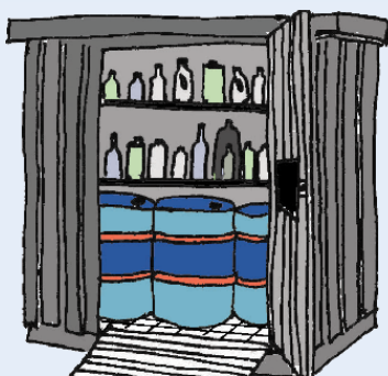
Figur 2: Udendørs opbevaring i container med dobbelt bund.
