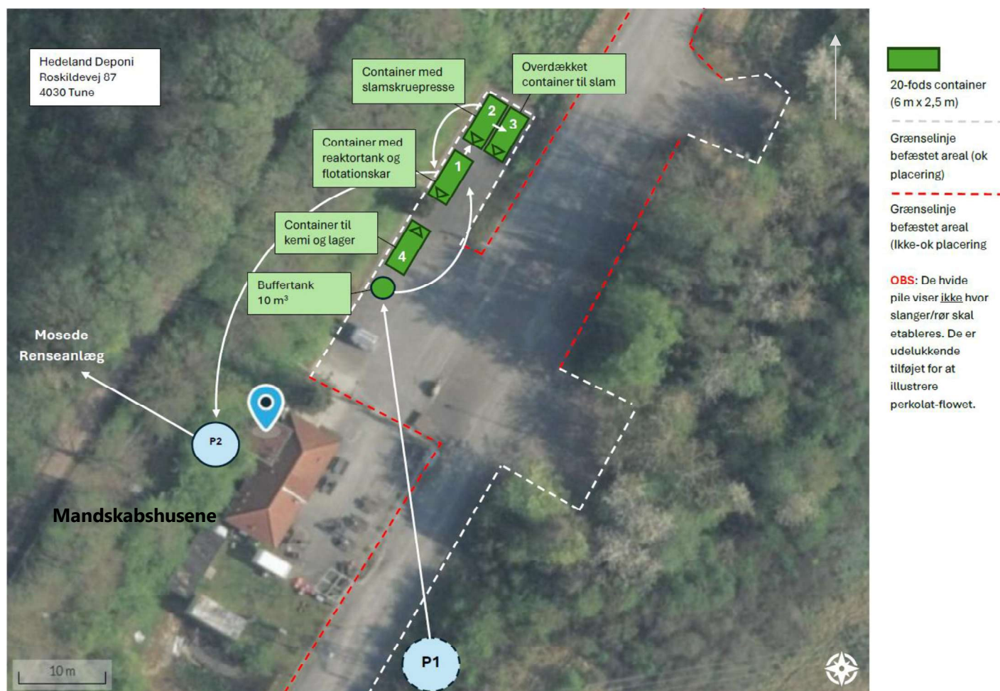
Figur 2.2 Placering og indretning af PFAS-renseanlægget på Hedeland Deponi. Kilde: figur fremsendt af ARGO I/S.
