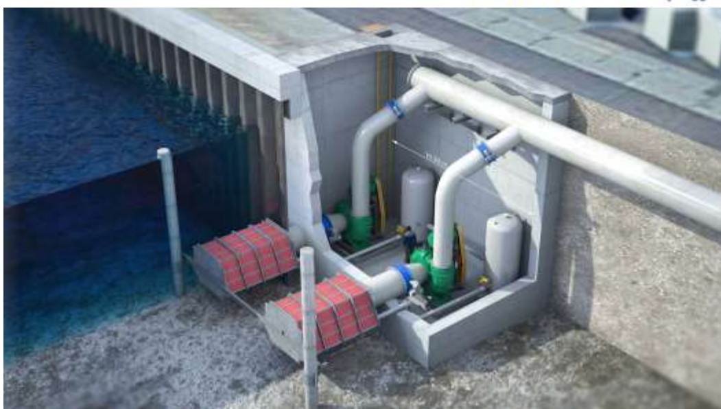
Figur 3-1. Eksempler på grovfiltre, som designmæssigt opfylder krav til fiskebeskyttelse i Tyskland (øverst) samt det forventede design af havvandsindtaget i Esbjerg Havn (nederst). Billeder er fra Taprogge.
