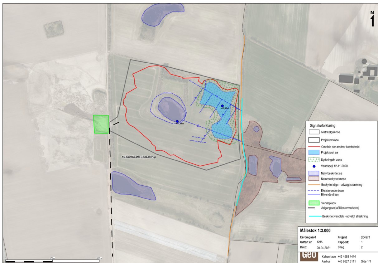
Figur 1 Oversigt over projektarealer med ny og eksisterende sø, dræn, dyrkningsfri zone samt vendeplads og adgangsvej.
