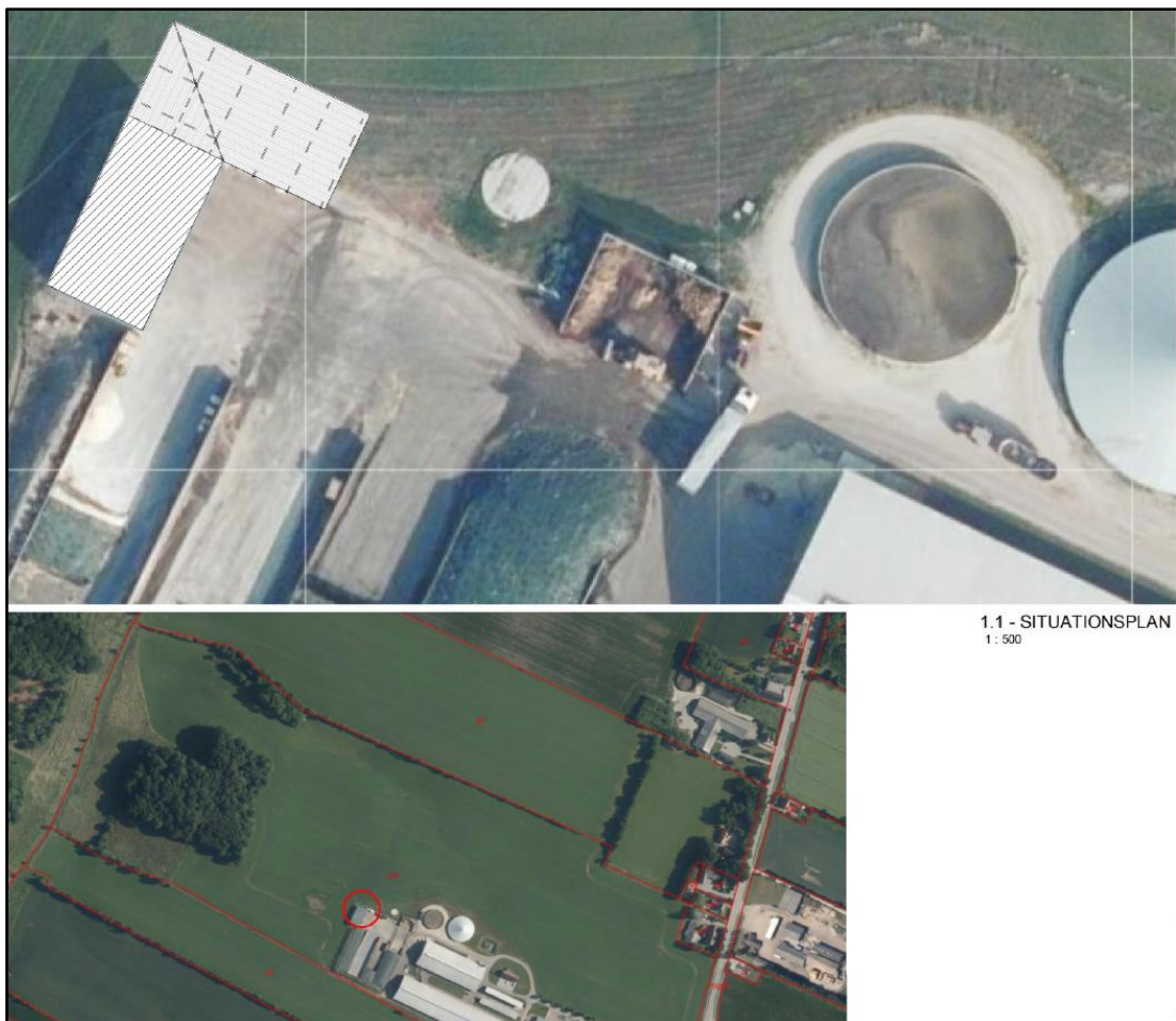
Figur 2 , uddrag af ansøgningsmateriale af den 3. februar 2023 om foderlade, ca. 275 m 2 i forlængelse af eksisterende råvarelager nordvest for staldanlæggene. Materialet er udarbejdet af HK Totalbyg A/S, Hornsyld Købmandsgaard A/S, Nørregade 28, 8783 Hornsyld. Den nye foderlade er vist med hvid farve og stiplede linjer. Eksisterende råvarelager er vist med skraveret sort på hvid baggrund.
