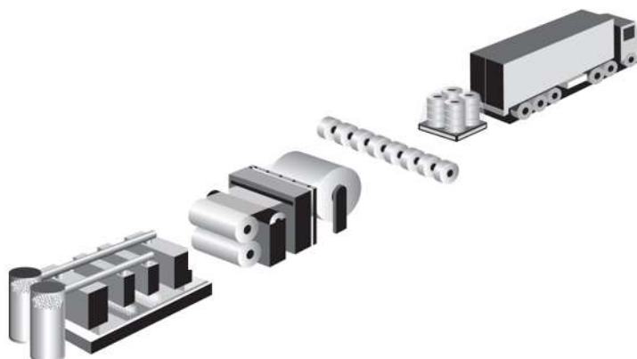
Figur 4 Fremstilling af spunbond-meltblown nonwovens
