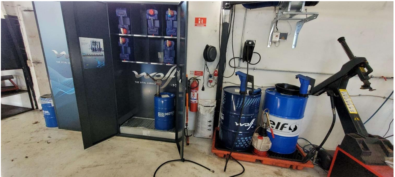
Opbevaring af flydende råvarer på spildbakke og i kemiskab med spildsikring.
