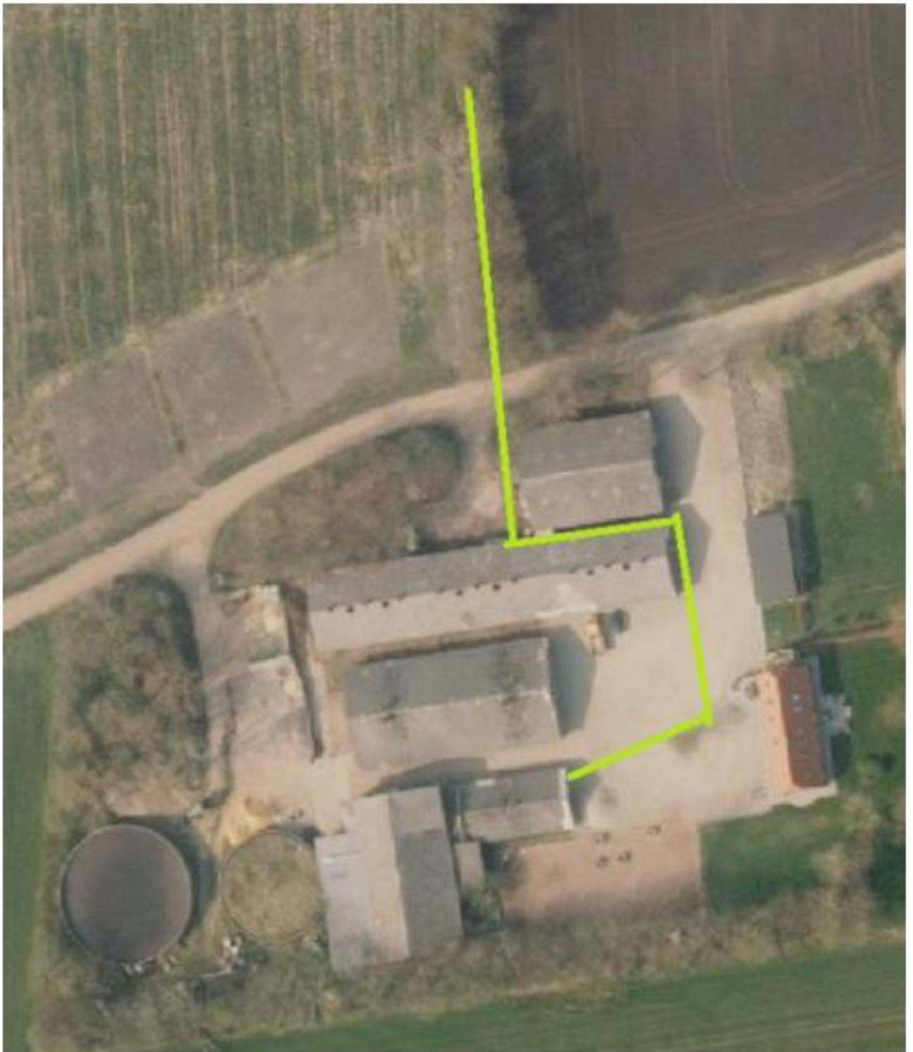
Afløbsplan – tagvand løber til nedsivning.
