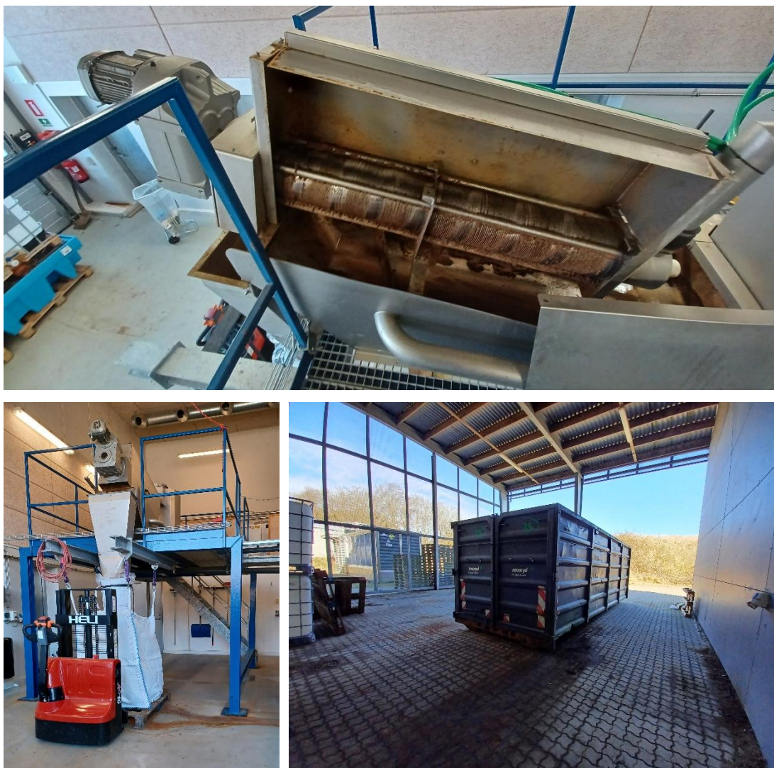
Figur 8. Slamopsamling og oplagring. Øverst: Slampresse. Nederst tv: opsamling af slam i linet big-bag. Nederst th: Container til oplag af slam i vognly.
