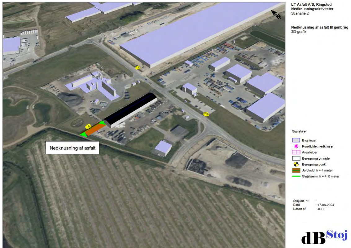
Figur 8 – Illustration af 3D-model for scenarie 2 med støjvold mod nord og skærm ved hal.
