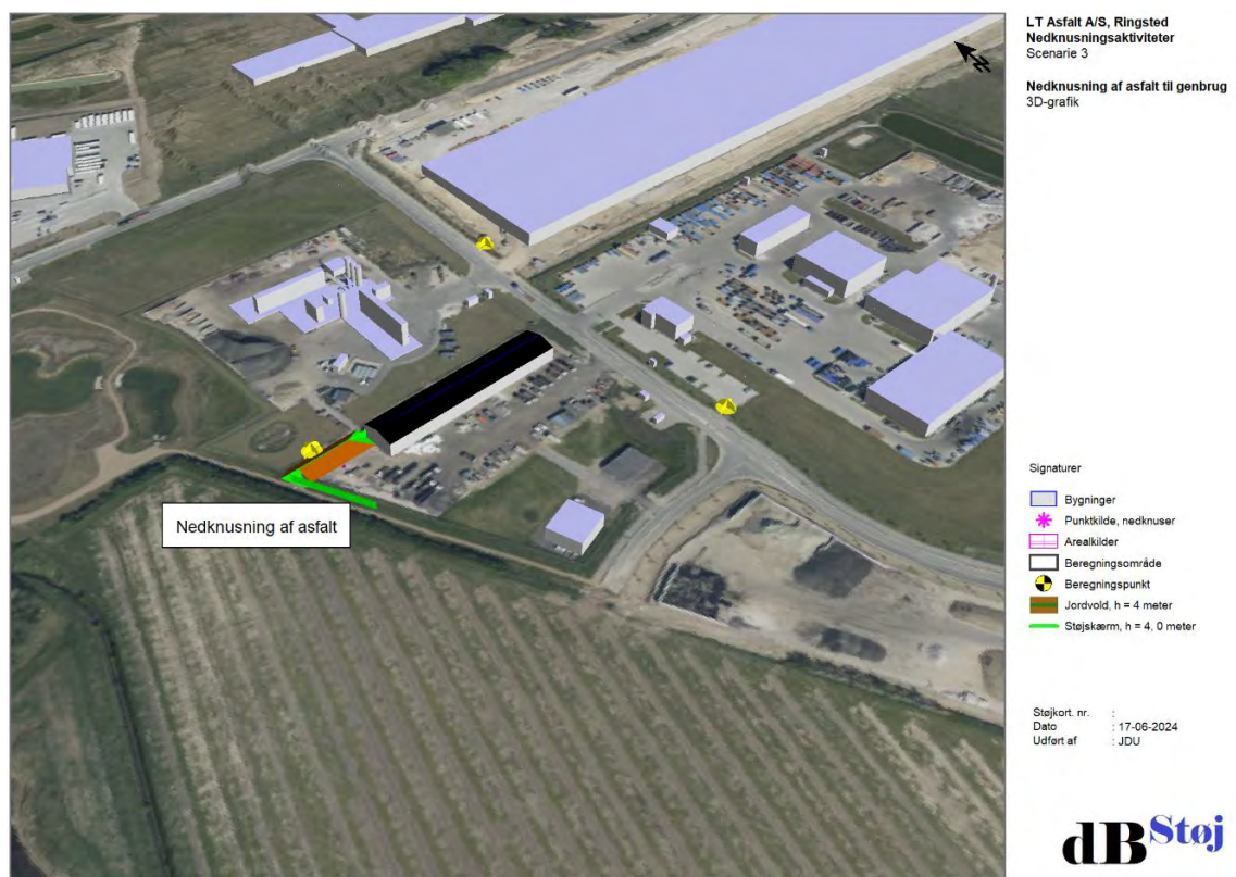
Figur 9 – Illustration af 3D-model for scenarie 3, med støjvold mod nord, skærm ved hal og en skærm langs med skel mod vest.
