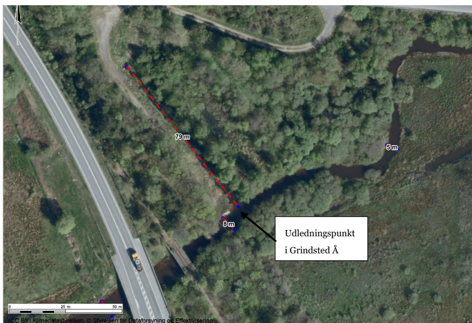
Figur 3.7 Grindsted Å med angivelse af udløbet fra det private rørførte vandløb. Bredden af Grindsted Å på forskellige delstrækninger.
