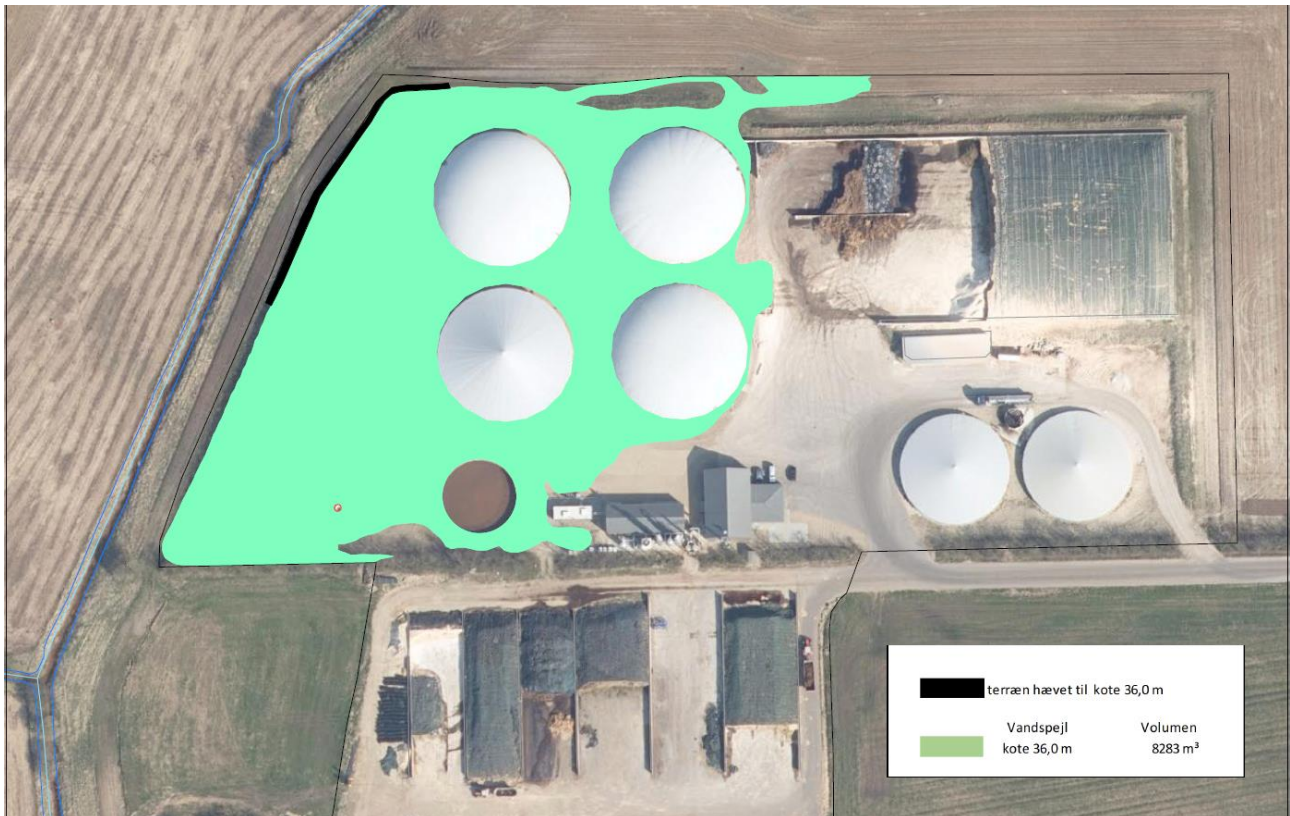
Figur 3. Luftfoto af anlæg med visualisering af hvorledes vandet vil fordele sig på pladsen.
