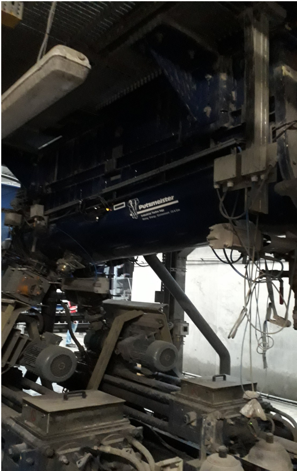
BILAG 5: Tilberedning af slurry (liggende blå tank øverst)
