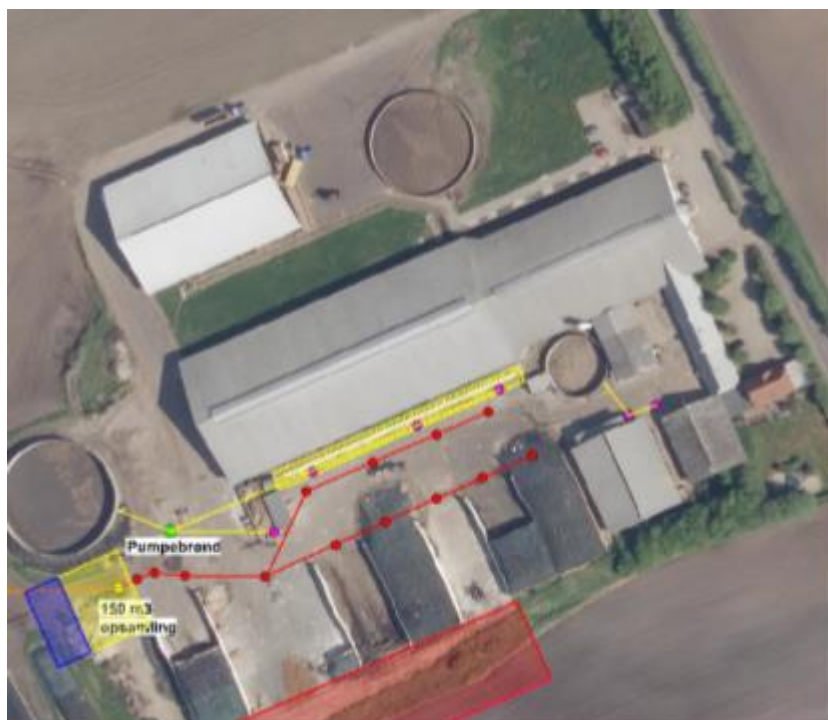
Figur 13. Afledning af overfladevand.
