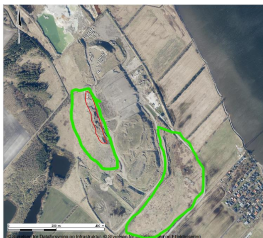
Figur 7 Luftfoto 2023. Med grønt er markeret slutafdækkede arealer pr december 2020. Med rødt ses oplag ovenpå slutafdækningen.
