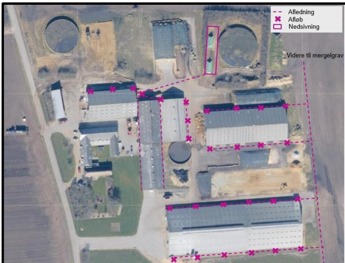
Figur 8 Aflledning af tagvand, som oplyst i MGK2023.
