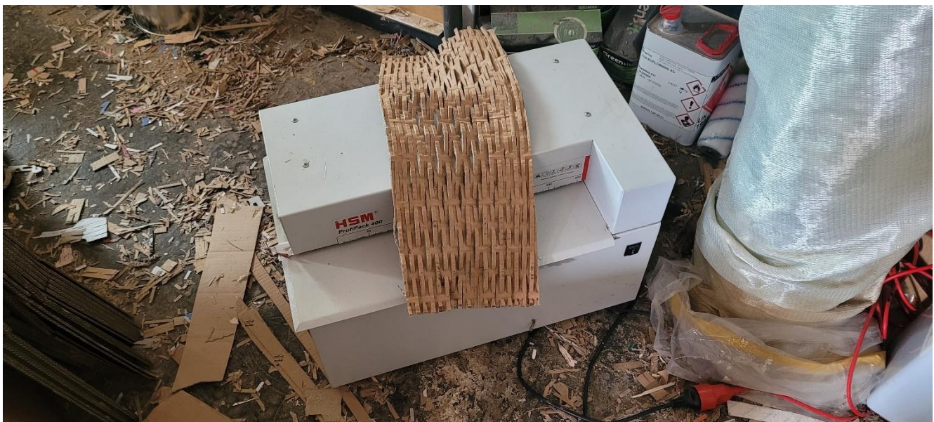
Papaffald genanvendes bl.a. ved at køre det gennem denne maskine, som laver det om til beskyttelsesfyld ifm. forsendelse via webshoppen.
