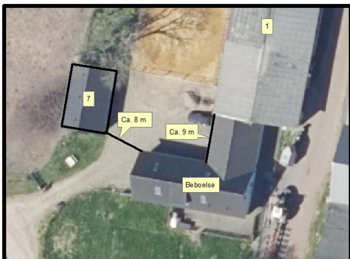
Figur 3. Manglende overholdelse af afstandskrav.
