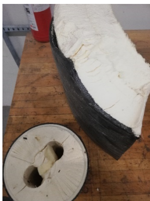
Kappestykke og fraktion af skrællet kappe før schredderen
