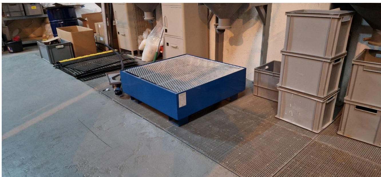
Spildbakken benyttes til omhældning af råvarer i tromler til dunke.
