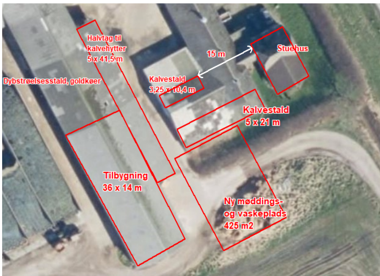
Figur 4: Nye staldefsnit, afstandskrav til stuehus fra ny kalvestald
