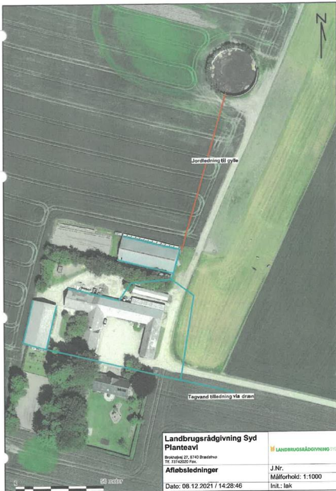
Afløbsforhold på ejendommen Brokhøjvej 27.
