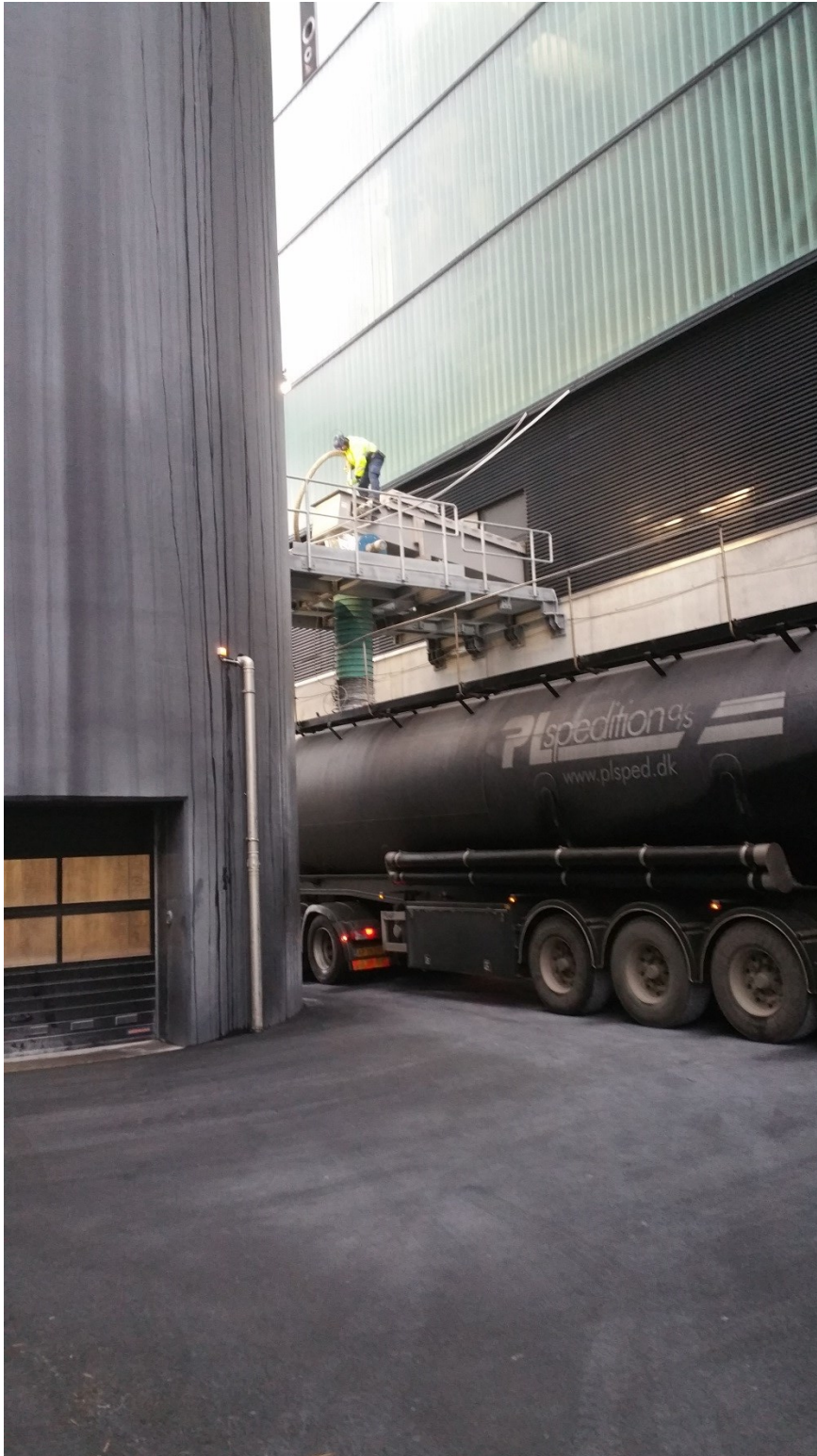
Afhentning af flyveaske i tankbil. I forbindelse med fyldning af tankbil skete der manuel håndtering af flyveaske i åbning direkte ind til det lukkede system.
