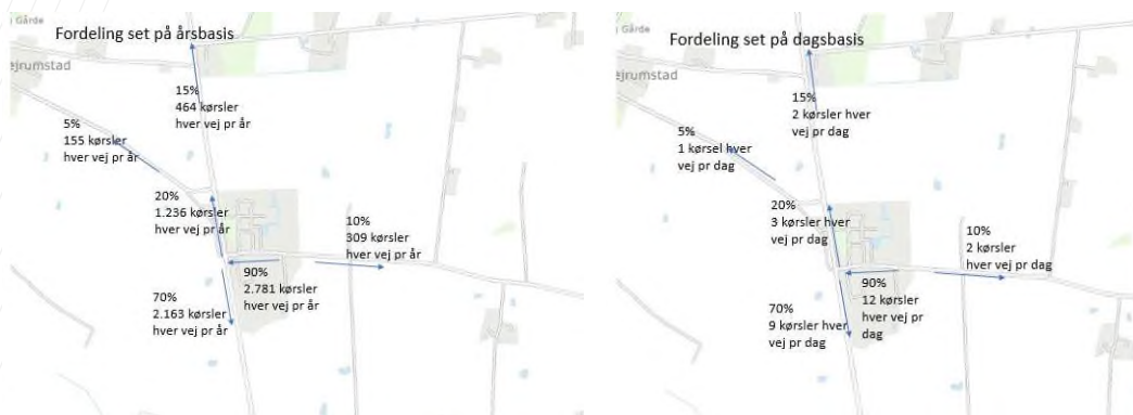
Figur 2.1: Estimat på antallet af kørsler til og fra det endelige Biogasanlæg, th. fordelingen pr. dag, tv. fordelingen pr. år (250 arbejdsdage). Estimeret af Dansk Biogas-Rådgivning.
