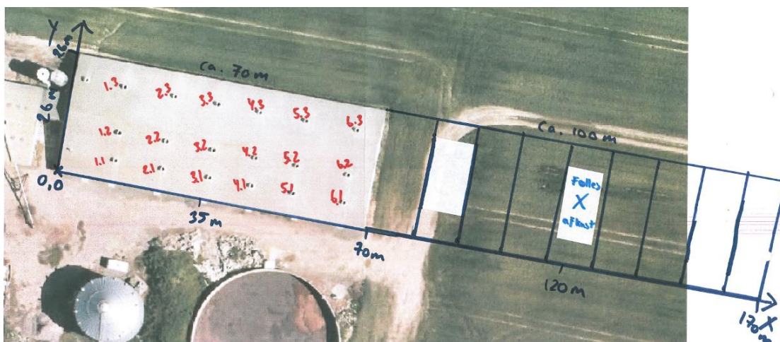
Figur 4: Placering af ventilationsafkast
