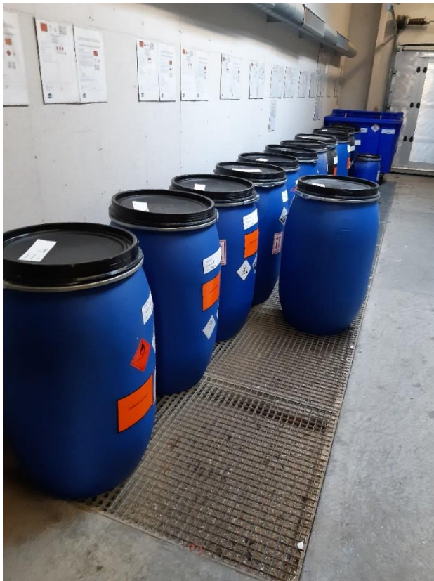
Figur 3: Indendørs opbevaring af farligt affald med opsamlingsvolumen til eventuelt spild.
