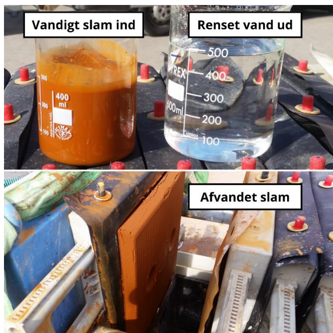
Figur 7-2: Slampresning fra en anden kunde som vandrensning.com har.
