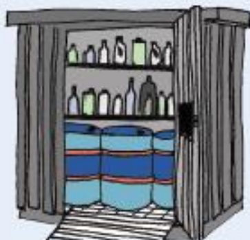
Figur 2: Udendørs opbevaring i container med dobbelt bund.
