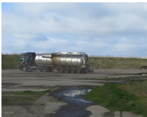
Tv: Gyllevogn der opsuger vand fra perkolattanken og lægger af i lagertanke.
