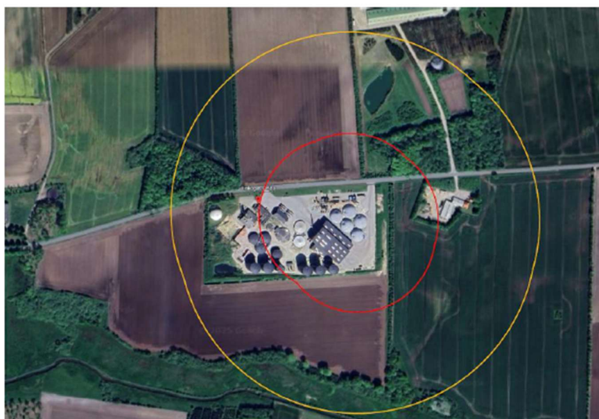
Figur 8: Konsekvensafstande ved eksplosionstryk 5 kPa (orange) og 20 kPa (rød) for dominoeffekt ved lagertanke.
