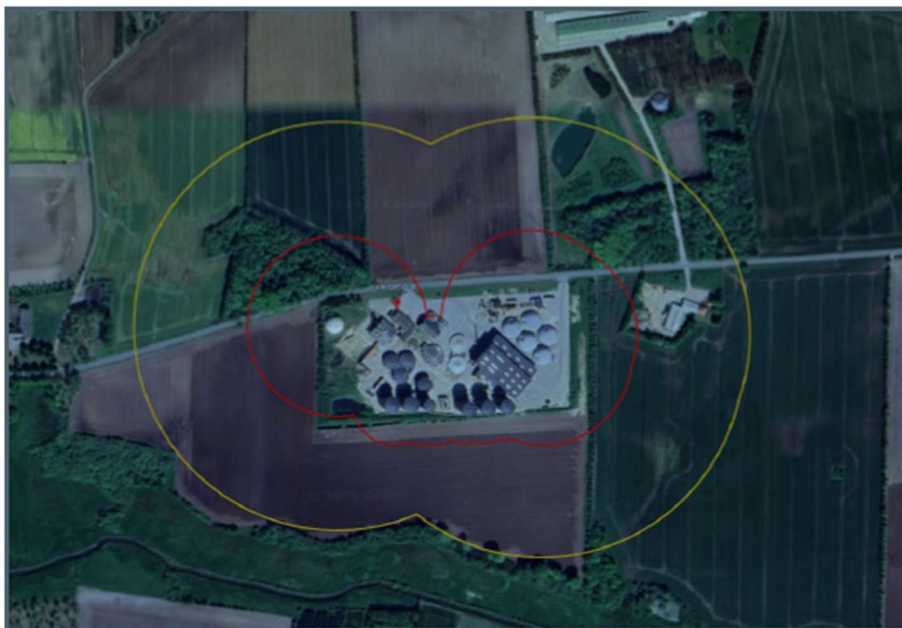
Figur 7: Konsekvensafstande ved eksplosionstryk 5 kPa (orange) og 20 kPa (rød) for enkelte tanke.
