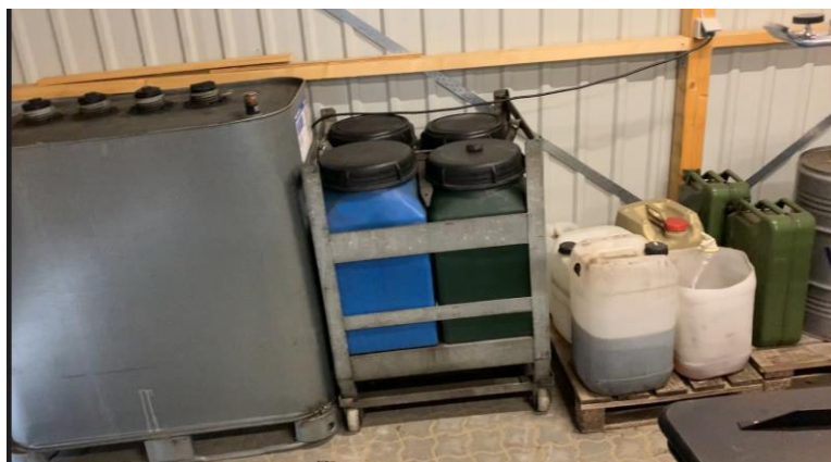
Foto af opbevaring af spildolie og råvarer på SF-stens belægning i dækrummet.
