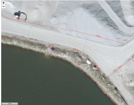
Figur 13b. Punktet markerer omtrentligt område, hvor det nedgravede rør føres gennem dæmningen på Etape 1. Forår 2016.
