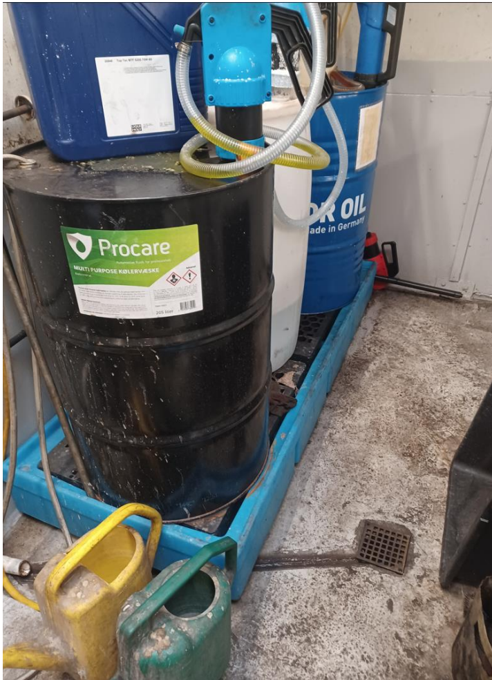
Billede 3. Kemikalier på en opsamlingsrist tæt på afløb med olieudskiller.
