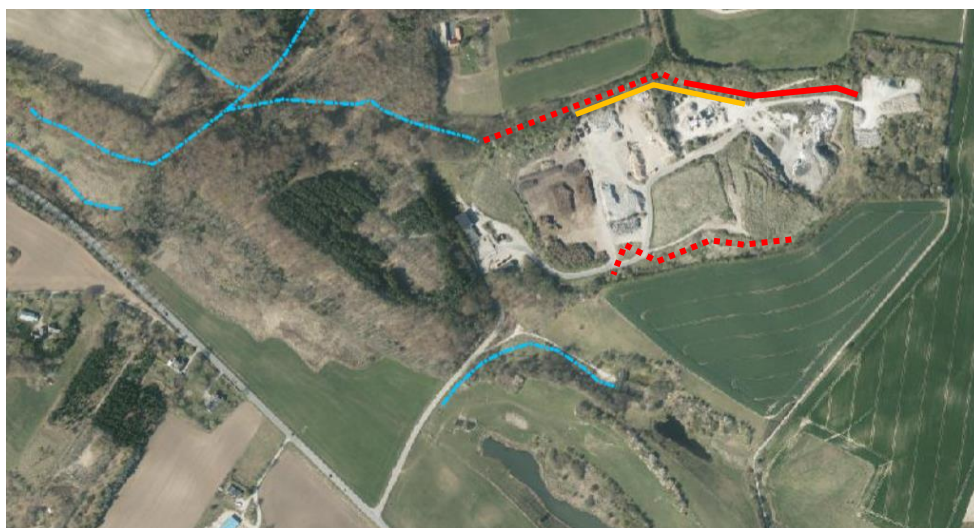
Oversigtskort 3. Forløb af dræn (kun den strækning som blev gennemgået på tilsynet er markeret). - - - nedgravede dræn, — nedgravede dræn suppleret af åbne grøfter, — volde mellem anlægget og grøfter/dræn, --- åbne vandløb.
